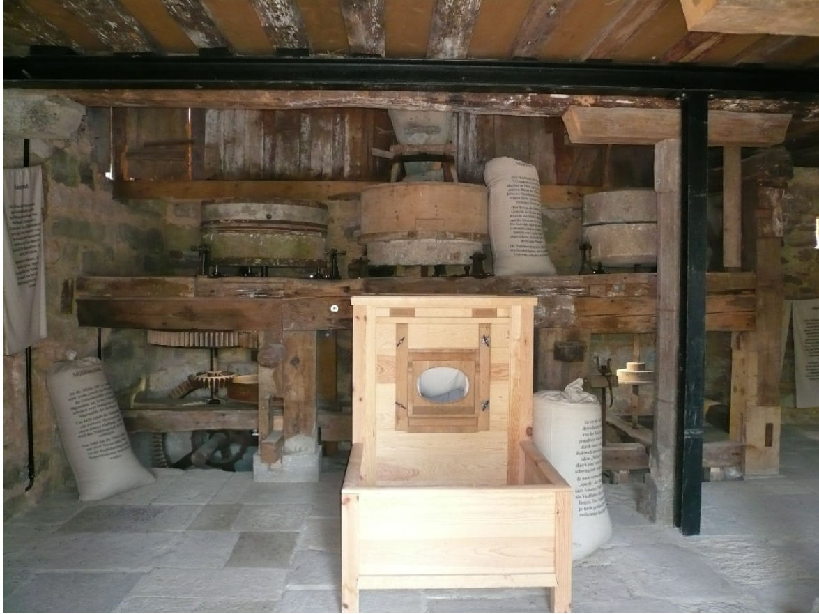
In het Hohenloher Freilandmuseum te Wackershofen (Schwäbisch Hall) is een uit Weipertshofen afkomstige molen met drie maalkoppels herbouwd. De te zeer versleten builkast werd exact nagebouwd en heeft geen kleiekotzer als afdekplaat. (foto auteur 27-6-2010)
